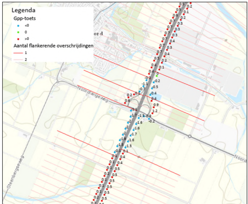
Figuur 14 Effect tweelaags ZOAB op hoofdrijbaan bij aansluiting Dinteloord en ten zuiden daarvan
