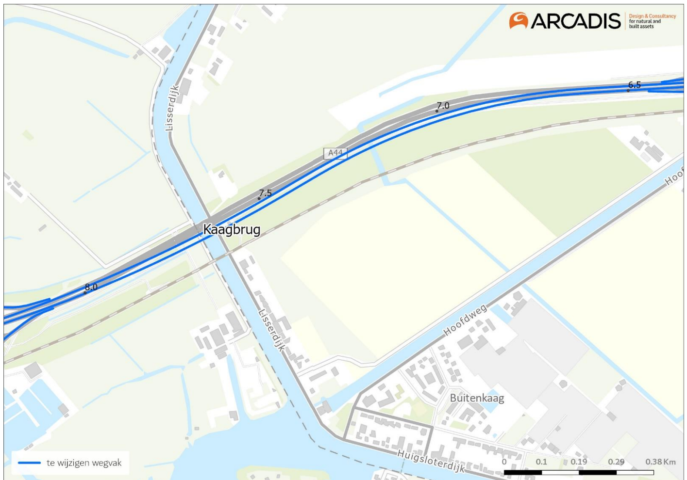
Figuur 4: verschuiven van de rijbanen ter hoogte van Kaagbrug
