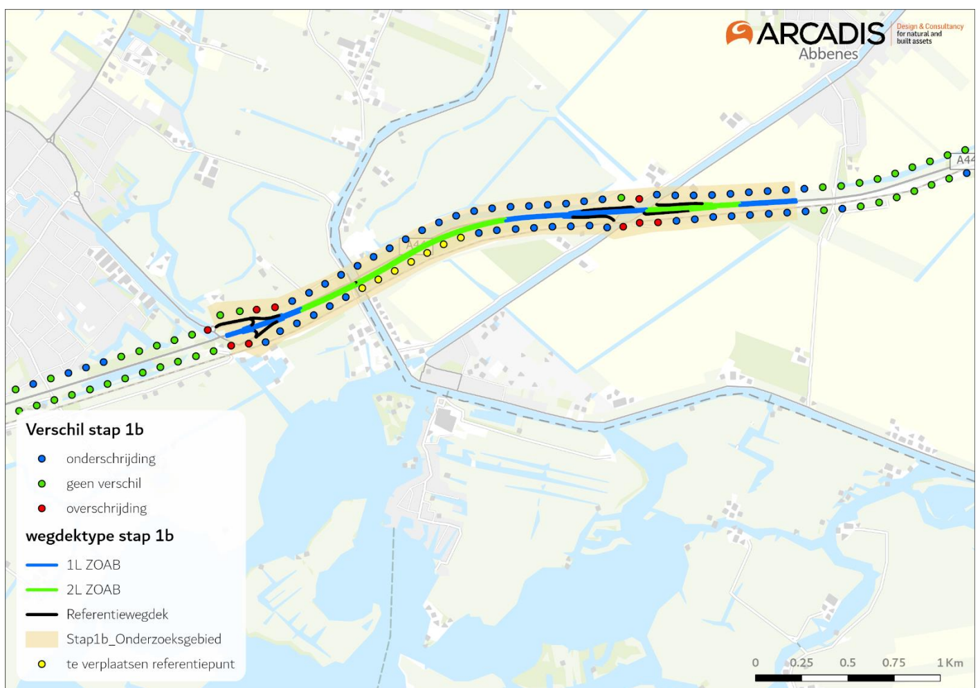
Figuur 11: resultaten van de toets op geluidproductieplafonds in de projectsituatie na toepassing van de bronmaatregel 2LZOAB op een deel van het wegvak (stap 1b) locatie Kaagbrug – Hoofdvaart
