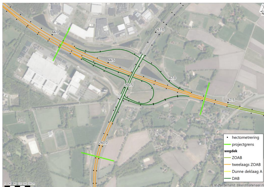
Figuur 10 Wegdekverharding projectsituatie
