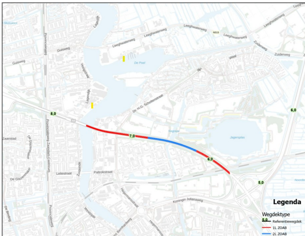
Figuur 15 weergave wegvak van de A8 waarvan het wegdek deels gewijzigd wordt van 1L ZOAB naar 2L ZOAB; Rood = 1L ZOAB, blauw = 2L ZOAB
