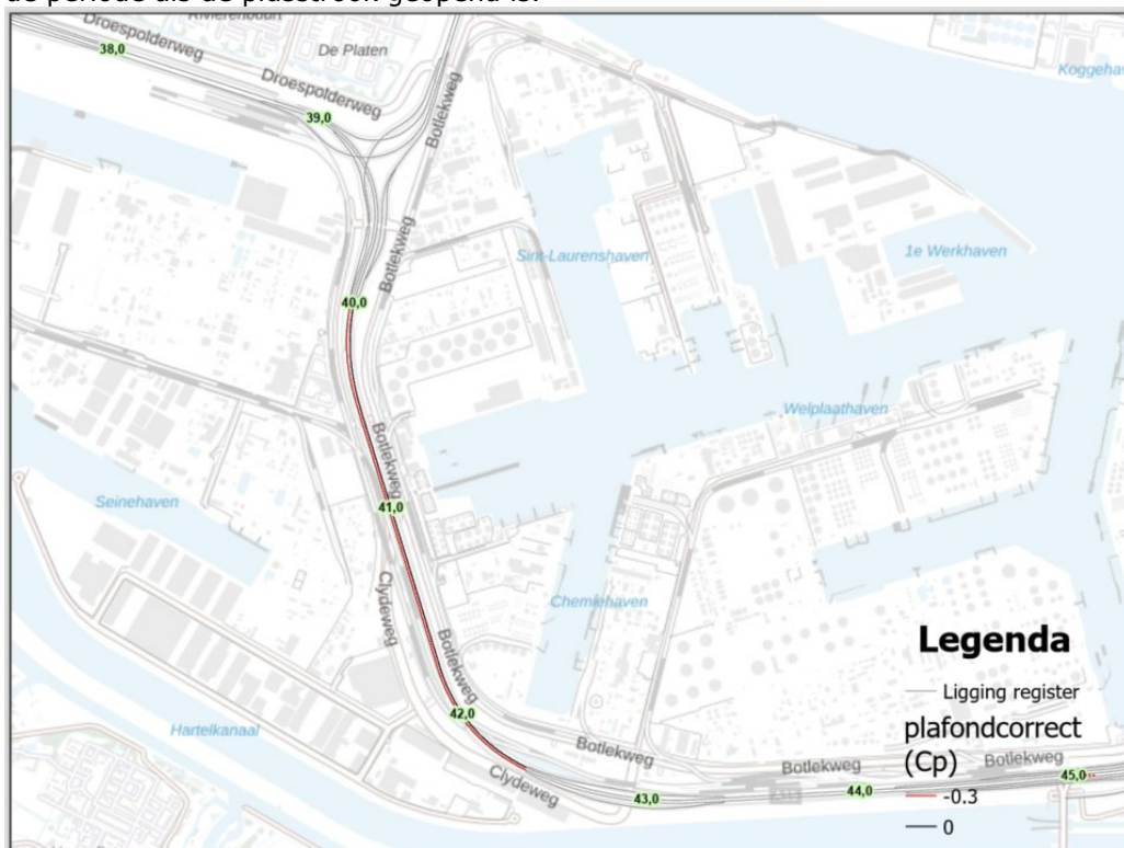
Figuur 4 Toegepaste plafondcorrecties. Zwart C_p = 0 , rood C_p = -0,3
