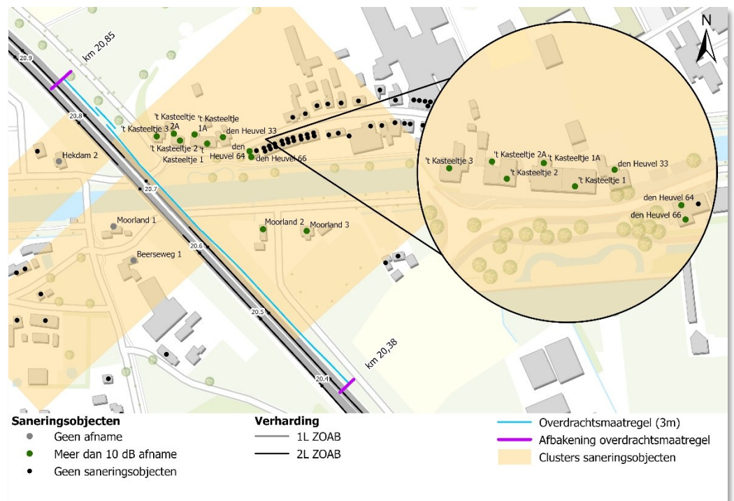
Figuur 3-2 Geluidreductie door aanvullende overdrachtsmaatregel cluster 3
