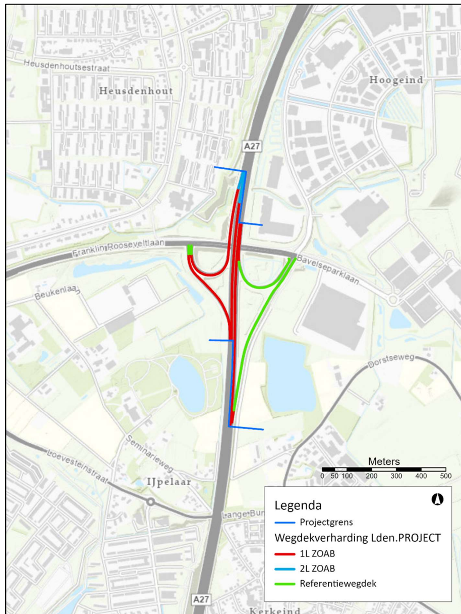
Figuur 9 Overzicht wegdekverharding projectsituatie
